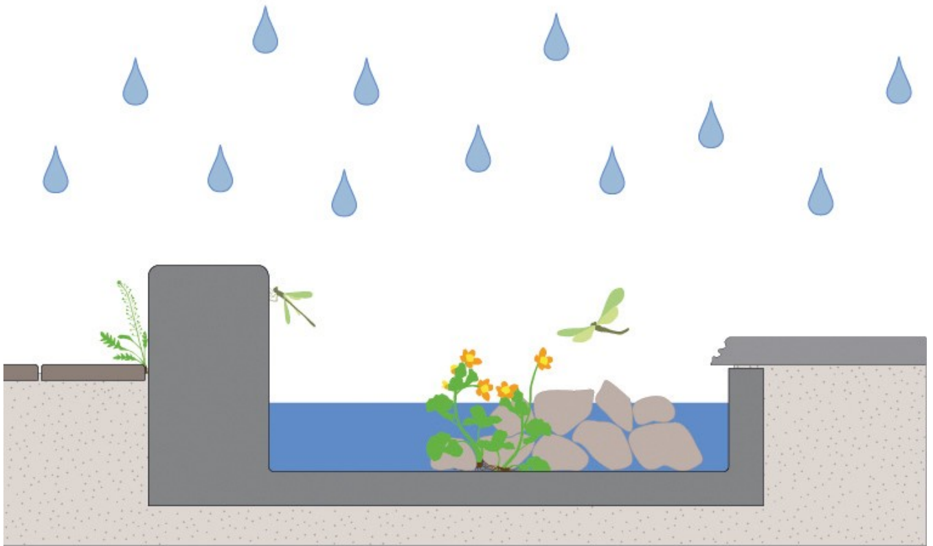
Schematische doorsnede open waterloop ©atelier GROENBLAUW
